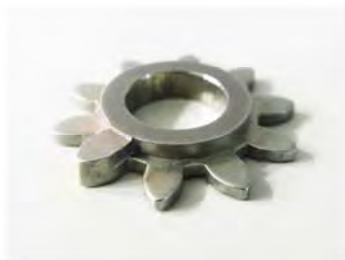
(図-68)FBによる板鍛造
