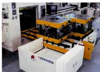
(図-59) 金型交換装置
