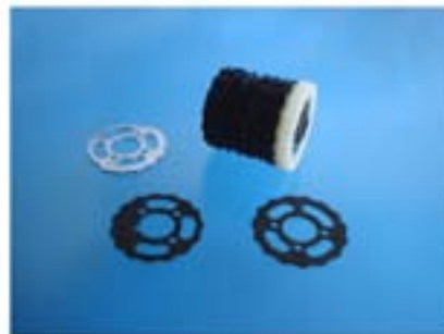
(図13) 初めて輸入したFBプレスで生産したブラザー工業のミシンのカム
